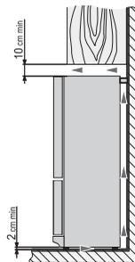
вверх, поворачивая против часовой стрелки – опускается вниз. Если установить холодильный прибор с небольшим наклоном назад – двери будут закрываться самопроизвольно.
